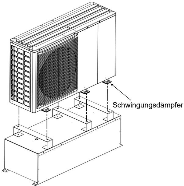
Antivibration : alle 6 Teile installieren (separat geliefert)
