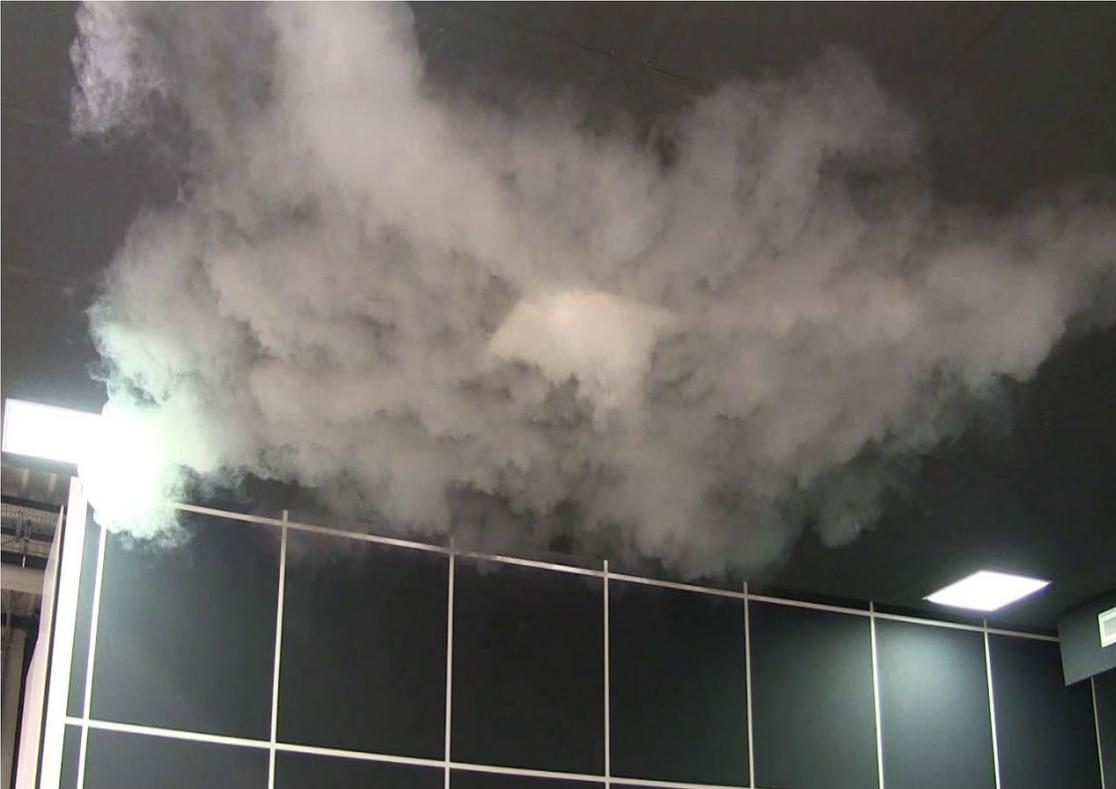
Der MDA erzeugt einen Coanda-Deckenstrahl, der sich mit der Raumluft vermischt bevor er sich von der Decke löst und behaglich zu Boden sinkt.
