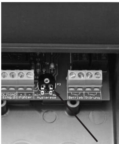
Abb. 4: Einstellung Schaltdifferenz
