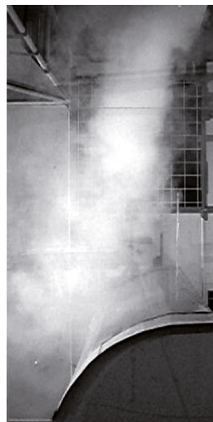
Bild 4: Wie von der DIN 10505 gefordert, bläst der Luftschleier nicht in die Verkaufstheke hinein, sondern schließt mit dem Außenbereich der Theke ab.
