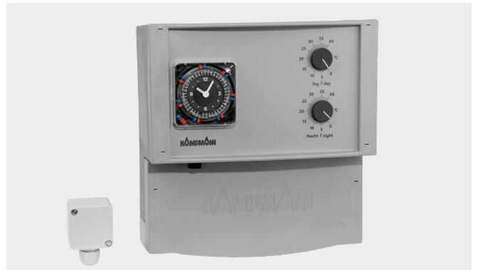
Schaltuhr mit elektronischer Raumtemperaturregelung und Raumtemperaturfühler Schaltuhr mit Tag-/Nacht-/Wochenprogramm, übersichtlich gestalteter Programmscheibe. Programmierbarkeit alle 5 min/30 min, kürzester Schaltabstand 20 min/2 h, 100 Stunden Gangreserve, Raumtemperaturregelung mit Tag- und Nacht-sollwertpotentiometer, umgeschaltet durch Schaltuhr, Raumtemperaturfühler in separatem Gehäuse (max. Leitungslänge 100 m).
