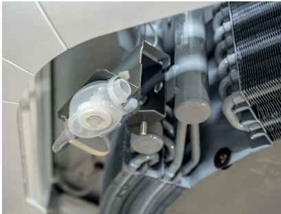
Schwimmerschalterbefestigung
