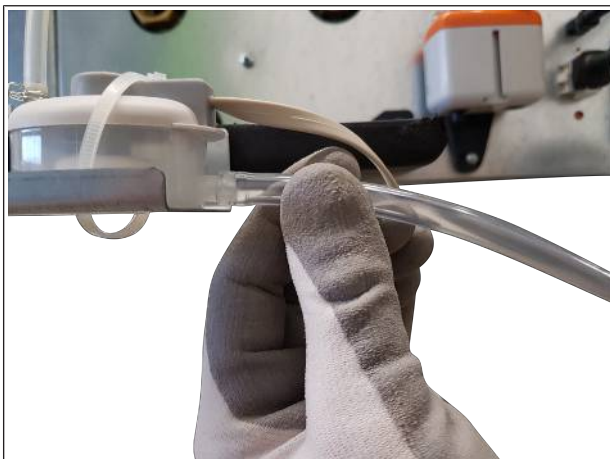
Abb. 27: Saugschlauch anschließen
