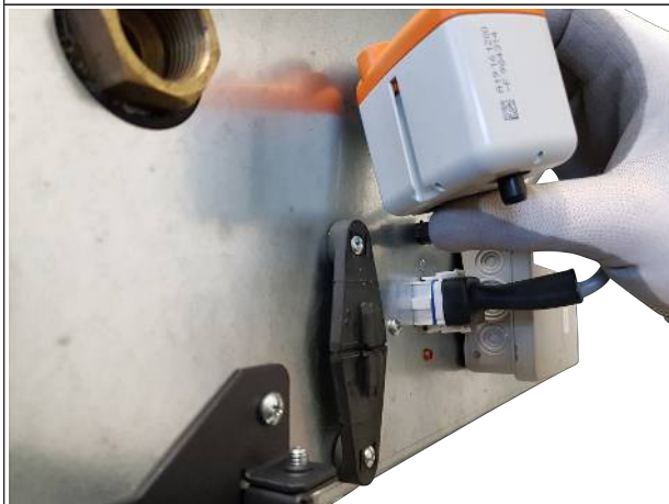
Abb. 25: Kondensatpumpe aufschieben
