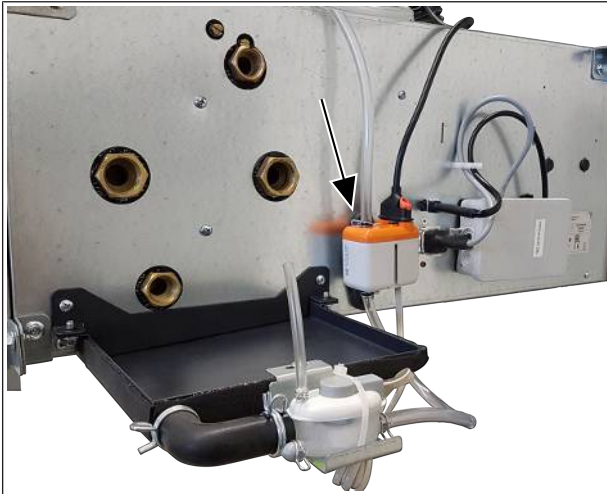
Abb. 30: Leitung Kondensatabfuhr anbringen
