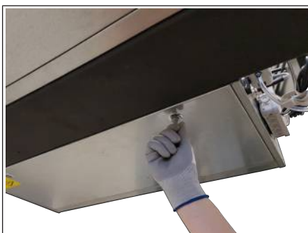
Abb. 50: Drehriegel öffnen
