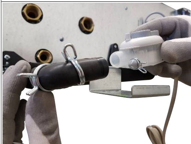
Abb. 23: Schwimmerschalter aufstecken
