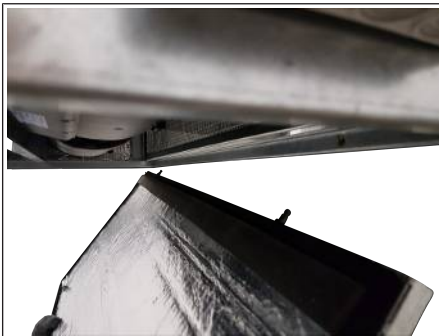
Abb. 53: Revisionsklappe einsetzen
