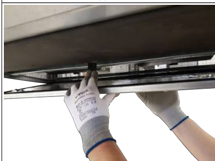
Abb. 52: Sicherungsblech eindrücken
