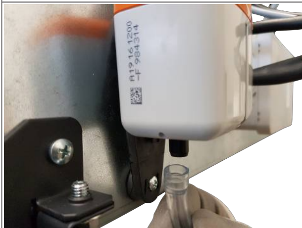
Abb. 28: Saugschlauch aufstecken
