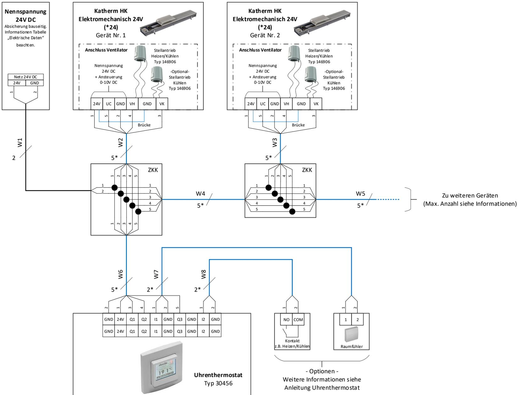
Katherm HK, elektromechanisch 24V, 2- oder 4-Leiter, Ventiltrieb(e) 24VAC/DC Auf/Zu, Ansteuerung über GLT
